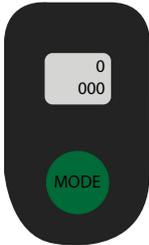
**MODE / RESET:** Wählen Sie die gewünschte Funktion aus. Halten Sie die Taste 3 Sekunden lange gedrückt um alle Werte auf die Werkseinstellungen zurück zu stellen.
